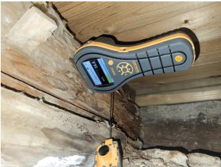
Kontroll i lukkede konstruksjoner ikke utført - Råteskader, fuktmåling og spor etter borrebille 3
