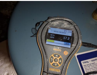
Synlige konstruksjoner - Fuktmåling
