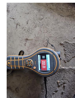
Utført kontroll i tiliggende konstruksjon - Fuktmåling
