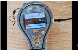
Kontroll i lukkede konstruksjoner - Fuktmåling
