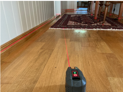
Nivellering gang2 etasje, ingen registrerte avvik
