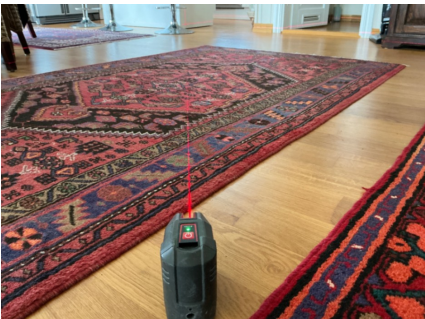
Nivellering gang2 etasje, ingen registrerte avvik
