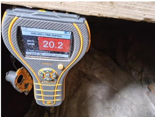
Stikktaking i treverk, fukt og fuktmålinger - Fuktmåling i krypekjeller under kjøkken
