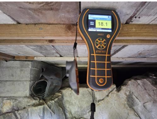
Stikktaking i treverk, fukt og fuktmålinger - Fuktmåling i krypekjeller med luke i grunnmur
