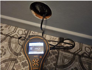
Utført kontroll i tiliggende konstruksjon - Fuktmåling bad 1. etasje
