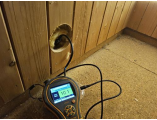
Utført kontroll i tiliggende konstruksjon - Fuktmåling bad 2 underetasje
