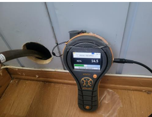
Kontroll i lukkede konstruksjoner - Fuktmåling i stuen
