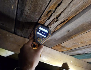
Synlige overflater (taktro, vegger, gulv, o.l) - Fuktmåling i råttent undertaksbord
