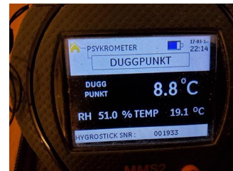
Utført kontroll i tilliggende konstruksjon - Fuktmåling
