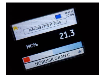
Stikktaking i treverk, fukt og fuktmålinger - Fuktmåling i bjelkelag
