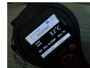
Utført kontroll i tilliggende konstruksjon - Fuktmåling
