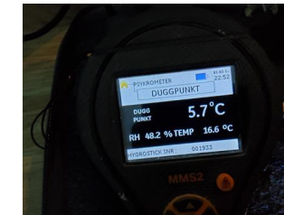
Utført kontroll i tilliggende konstruksjon - Fuktmåling
