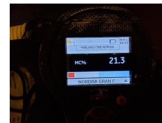
Overflate gulv - Fuktmåling
