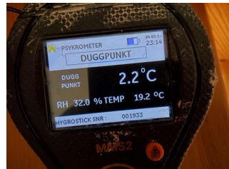
Utført kontroll i tiliggende konstruksjon - Fuktmåling
