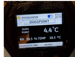
Utført kontroll i tiliggende konstruksjon - Fuktmåling
