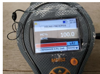
Overflate gulv - Fuktmåling gulvflater i benkeskap
