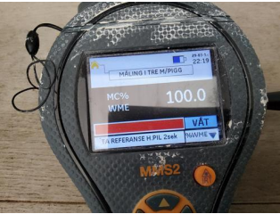
Overflate gulv - Fuktmåling gulvflater i benkeskap
