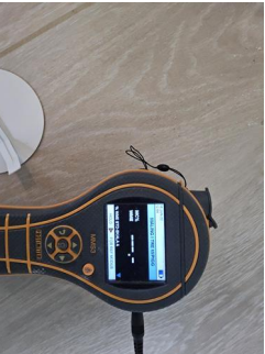
Utført kontroll i tiliggende konstruksjon - Fuktmåling
