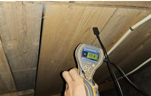
Stikktaking i treverk, fukt og fuktmålinger - Forhøyede fuktverdier i panel
