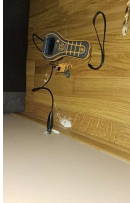
Kontroll i lukkede konstruksjoner - Fuktmåling i vegg mot terreng.
