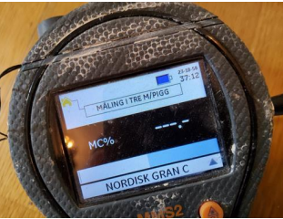
Utført kontroll i tilliggende konstruksjon - Fuktmåling
