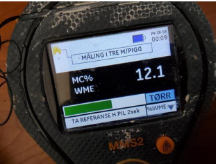
Kontroll i lukkede konstruksjoner - Fuktmåling
