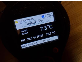
Utført kontroll i tilliggende konstruksjon - Fuktmåling
