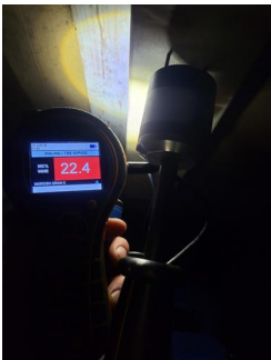
Stikktaking i treverk, fukt og fuktmålinger - Målinger i stubbloft og bjelker
