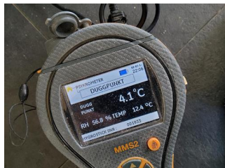
Utført kontroll i tiliggende konstruksjon - Fuktmåling
