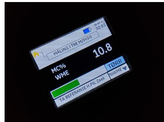
Stikktaking i treverk, fukt og fuktmålinger - Fuktmåling
