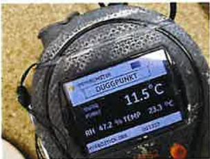
Utført kontroll i tiliggende konstruksjon - Fuktmåling
