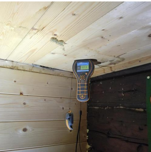
Helhetsvurdering - Eksempel på fuktmåling og fuktmerker i gang
